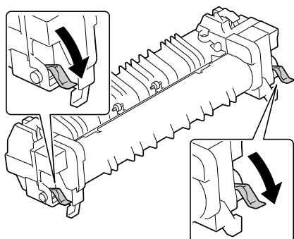
8 定着ユニットを金属板に載せ、スライドさせて止まるまで押し込みます。
