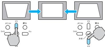
本機の傾斜角度が上下に約 30° までであれば補正できます。
