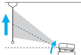
本機を傾けると映像が台形状にゆがみます。台形ゆがみは次の操作で補正します。
