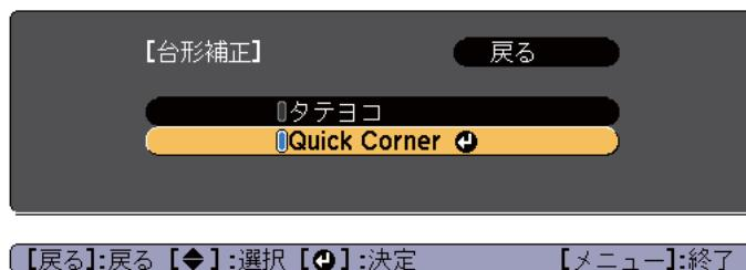
4 補正するコーナーをリモコンの【↖】【↗】【↙】【↗】ボタン、または操作パネルの【↖】【↗】【↙】【↗】(または【ワイド】【テレ】)ボタンで選択して、【↔】ボタンを押します。
