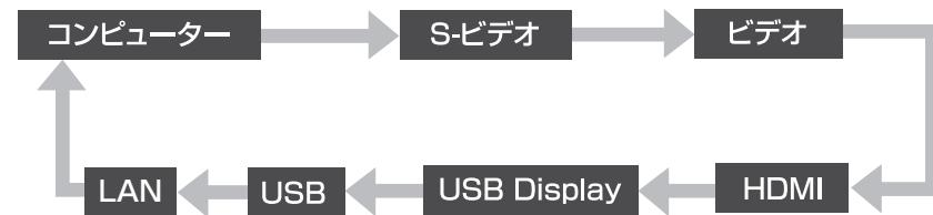
複数の機器を接続しているときは、目的の映像が投写されるまで【入力検出】ボタンを繰り返し押します。
