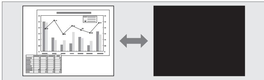
【A/Vミュート】ボタンを押す、またはレンズカバーを閉/開するたびにA/Vミュートが実行/解除されます。
