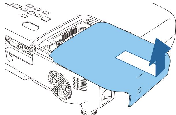
**1** 本機の電源を切り、「ピッピッ」と終了音が鳴ってから電源コードを外します。
