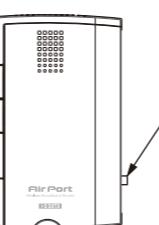
アンテナ端子およびアンテナ線接続部が熱くなります。
