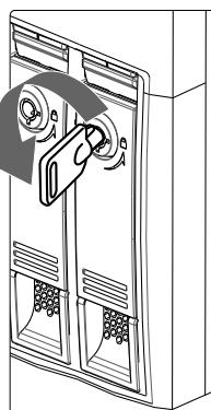
添付のロックキーを [ カートリッジ固定ロック ] に合わせ縦向きに挿し、反時計回りにまわして、[LOCK] にする
