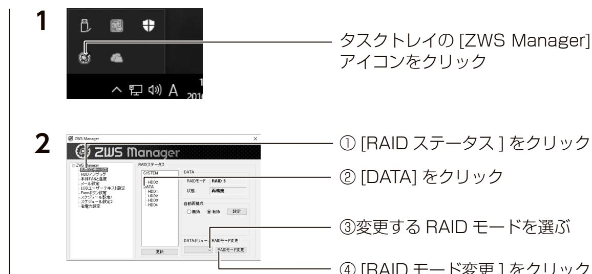
選択した [RAID モード] への変更を開始します。([状態] が再構築中になります。)
