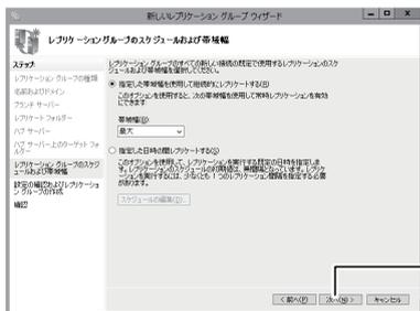
※ WAN 接続などの帯域幅に余裕がない場合、帯域幅の調整とレプリケーションの実行スケジュールを設定できます。
