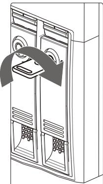
添付のロックキーを [ カートリッジ固定ロック ] に合わせ横向きに挿し、時計回りにまわして、[UNLOCK] にする
