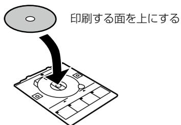
7 ディスクトレイをプリンターに挿入します。プリンター側とトレイ側のマークを合わせてください。
